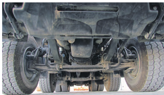
Gerade Vorderachsen sorgen für optimale Bodfreiheit, die Stabis liegen gut versteckt vor den Achsen
