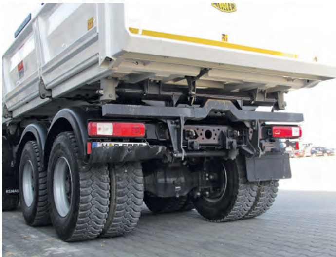
Der Unterfahrschutz ist kräftig und entsprechend schwer. Für den Fertiger lässt er sich hochklappen
