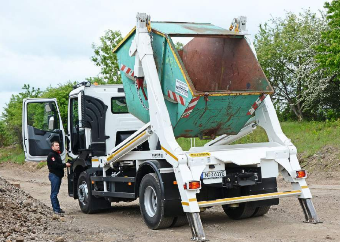
Dank Spannstempel bleibt der Behälter straff mit den Hubarmen verbunden, gezieltes Über-Kopf-Stellen klappt
