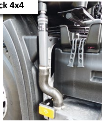
Der 30-Liter-Ölvorrat für den Vorderradantrieb sitzt direkt hinter der Achse. Der lange Schnorchel mit Filter liefert Luft zur Entlüftung
