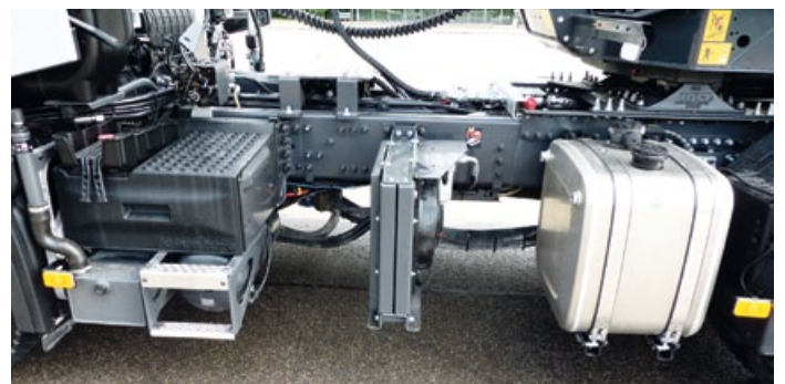
Die linke Seite gehört ganz der Hydraulik. Der Tank rechts bedient die Kipp hydraulik, die Optitrack-Kühler-/Lüftereinheit benötigt viel Platz um effektiv arbeiten zu können
